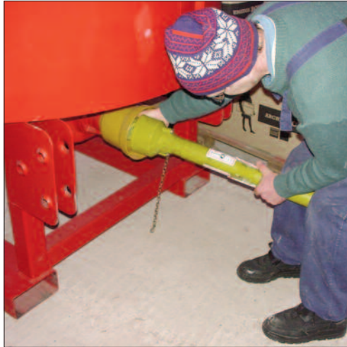
1) Montage der Gelenkwelle an den Power-Sandking
