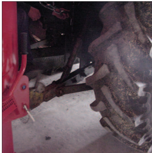
3) Power-Sandking an Dreipunkthängung anstecken
