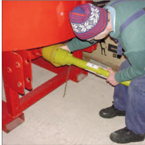
1) Montage der Gelenkwelle an den Power-Sandking
