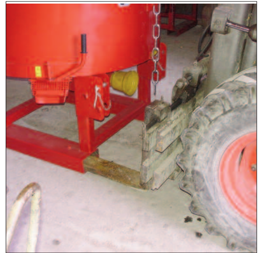
Transport des Power-Sandking mittels Gabelstapler
