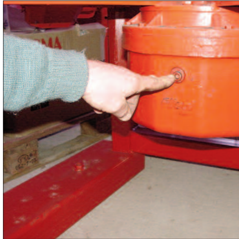
2) Öleinfüllschraube (Winkeltrichter verwenden)
