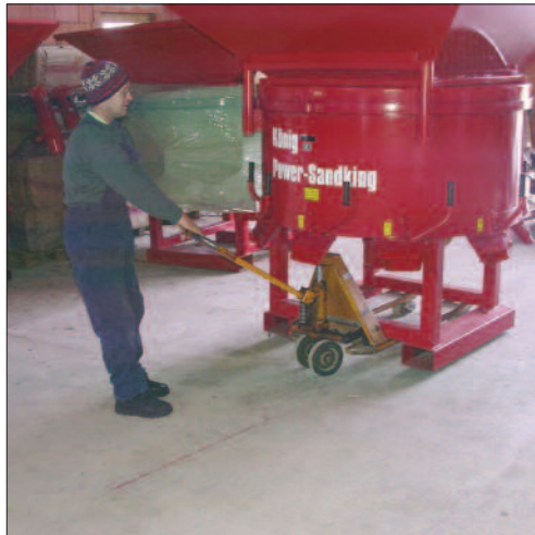
Transport des Power-Sandking mittels Hubwagen zum Versetzen in Hallen auf ebenen und befestigten Boden
