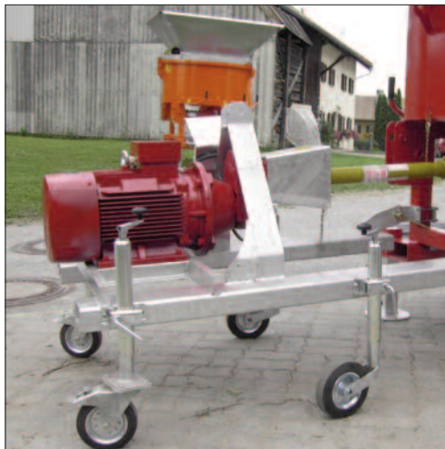
3) Antriebsmotor zum Mischbehälter schieben
