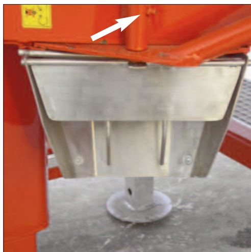
5) Schmierstelle am Abfüllstutzen kontrollieren/nachfetten
