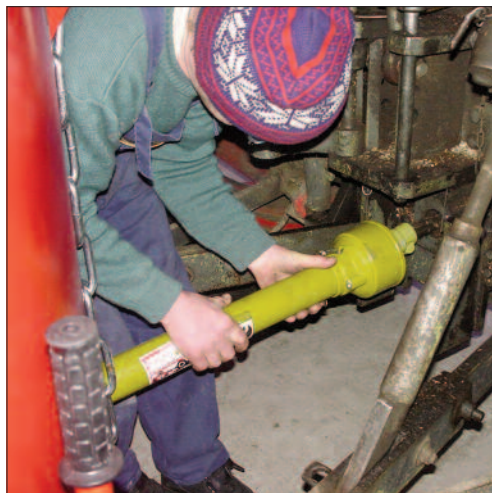
5) Gelenkwelle an Traktor anstecken und sichern
