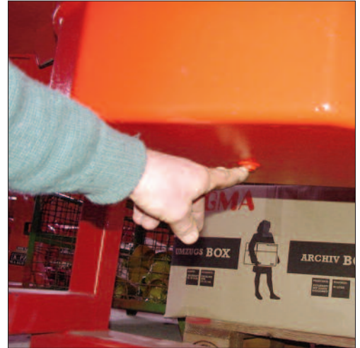
2) Ölablaßschraube am Getriebe
