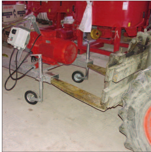
Transport des Antriebsmotors mittels Gabelstapler
