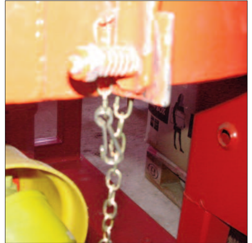
2) Gelenkwelle mit Kette an beiden Enden (Anlage und Antriebsgerät) sichern
