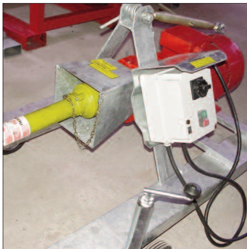
5) Gelenkwelle an Antriebsmotor anstecken und sichern
