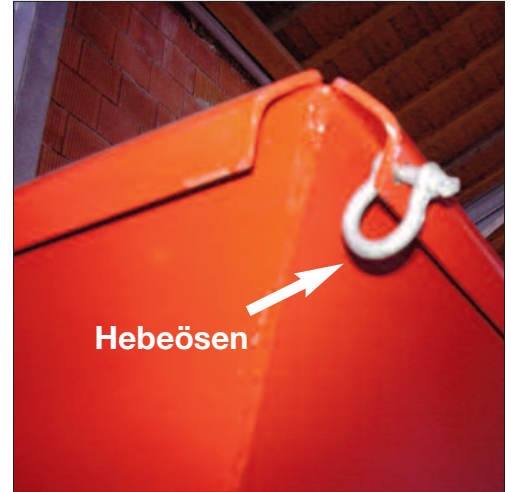
2) Hebeösen mit 4-fach Gehänge zum Entfernen des Einfülltrichter verwenden (nicht zum Versetzen der Anlage)
