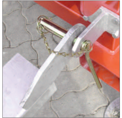
4) Mit dem Mischbehälter verbinden (Sicherheitsbolzen mit Kette)
